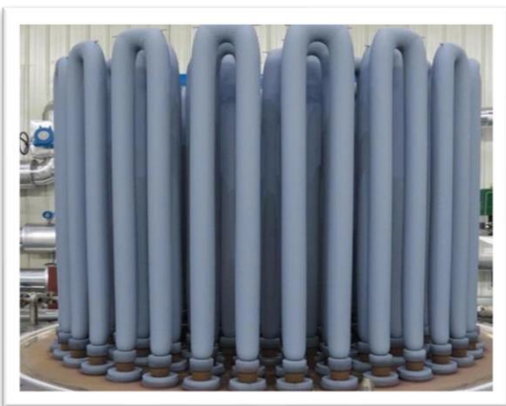
图 4：棒状硅形貌图
