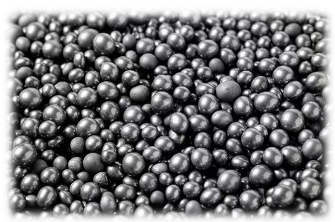
图 5：颗粒硅形貌图
