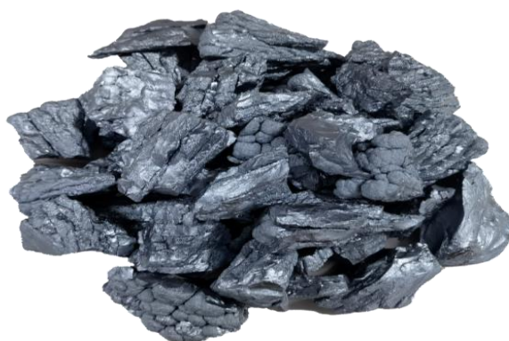
图 8：多晶硅珊瑚料形貌图
