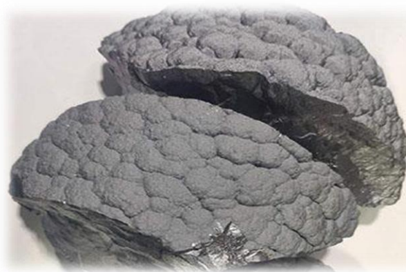
图 7：多晶硅菜花料形貌图
