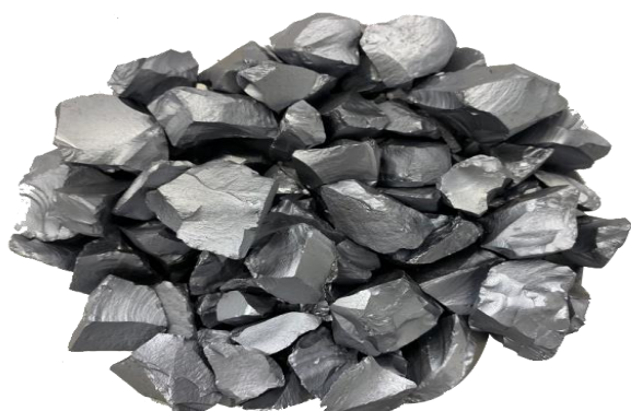
图 6：多晶硅致密料形貌图
